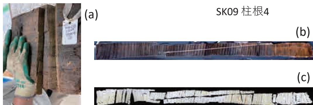
図7. SK09 柱根 4 からの分析試料の切り出し (a)、その木材薄板 (b) とセルロース薄板 (c)
