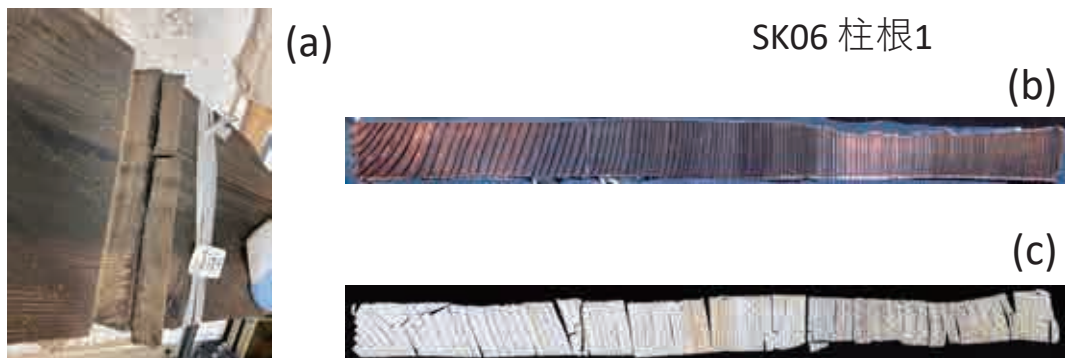
図4. SK06 柱根 1 からの分析試料の切り出し (a)、その木材薄板 (b) とセルロース薄板 (c)
