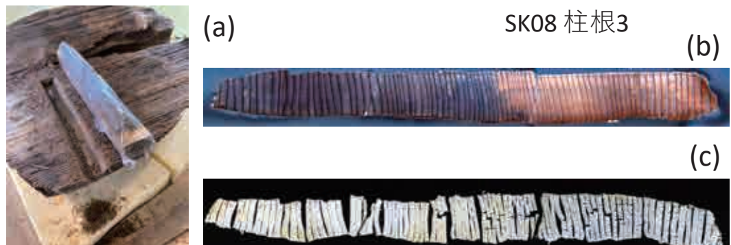
図6. SK08 柱根 3 からの分析試料の切り出し (a)、その木材薄板 (b) とセルロース薄板 (c)
