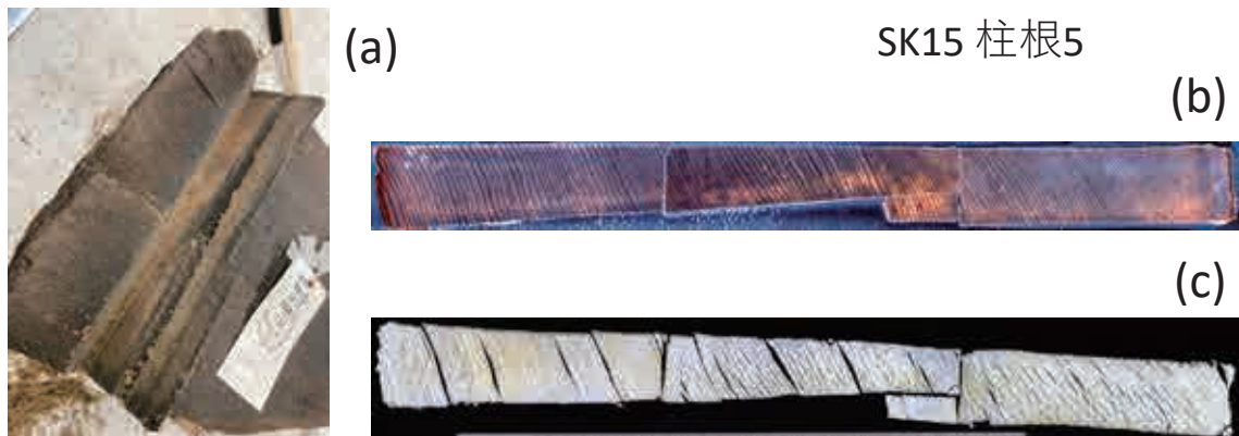
図8. SK15柱根5からの分析試料の切り出し (a)、その木材薄板 (b) とセルロース薄板 (c)
