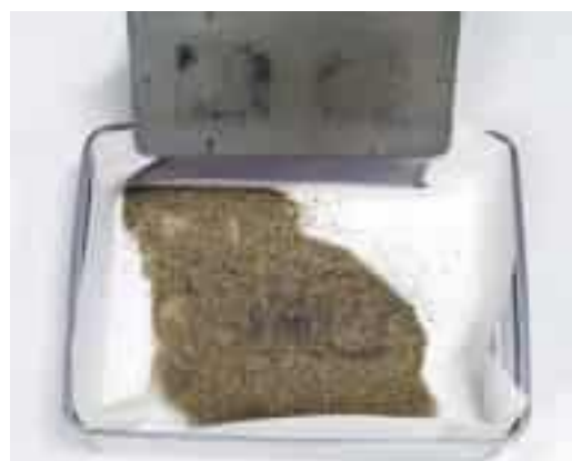
第 7 図 マグネット式吸着器についた砂鉄
