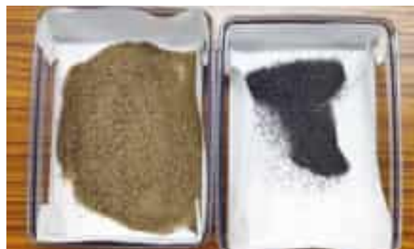
第 10 図 安原浜砂の鉄分の分離
