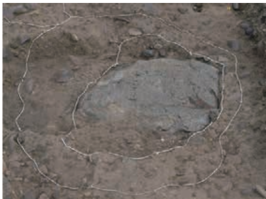
図4 礎石根固め (大型石材埋設タイプ)
