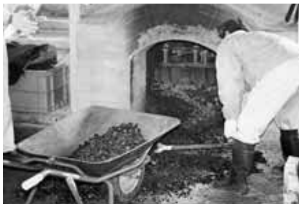
写真13 窯出し時のオキの状況
