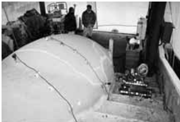
写真6 熱電対温度計などの配置の様子
