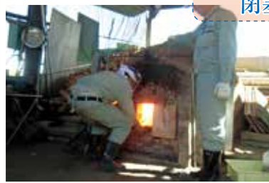
高温のなか、焚口をレンガ等で閉じます
